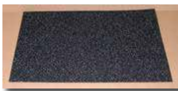
Mousse conductrice & dissipatr à cellules fermées
